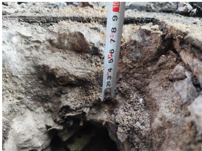
foto /17/ Pohled na odměřování vrstvy betonového a křemičitého písku, tl. 85 mm
